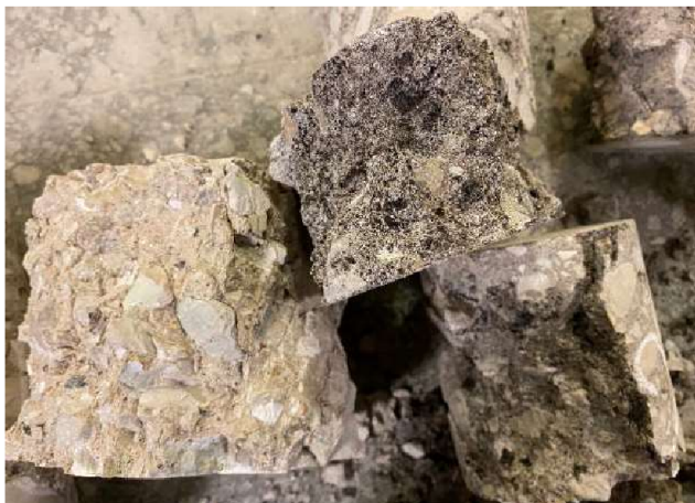
Joonis 7.4. CFB tuhaga stabiliseeritud proovikehade võrdlus peale survetugevustesti läbimist: vasakul on ilma freespuruta Simuna-Vaiatu proovikeha ja paremal freespuruga Narva-Mustajõe; viimane on rabedama ja „pehmema“ koostisega.
