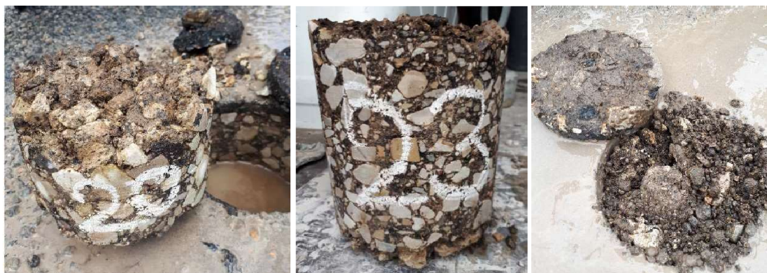
Joonis 7.9. Puurkehad nr 20, 23 ja puurauk nr 30. Puurkehad on võrreldes tuhkestabiliseeritud kihiga selgelt nõrgemad ja halvemas seisukorras. Mass-stabiliseerimata turbaga lõigult ei olnud võimalik kätte saada ühtegi tervet puurkeha.
