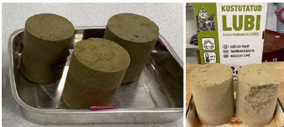
Joonis 7.16. 8% põlevkivituha kasutamine võimaldas kuivatada pinnast niivõrd, et sellest sai vormida standardse Proctoriga proovikehad. Sama tulemus saavutati 6% kustutatud lubjaga.
