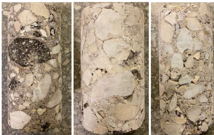
Joonis 7.5. Näited survetugevuse läbinud proovikehadest Narva-Mustajõelt, millest nähtub see, et segude terakoostised on kohati tasakaalust väljas.
