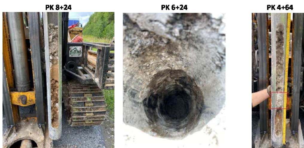
Joonis 7.6. Ristlõige PK 8+32, vana stabikiht ei ulata tänase teekatte alla täies laius. PK 6+24, põikpragu ulatub läbi asfaltkatte kui uue stabikihi kuni vana betoonitaolise kihini. PK 4+64 oli vana stabikiht nõrk, mida oli võimalik proovliga läbistada (märgistatud punase ristkülikuga)
