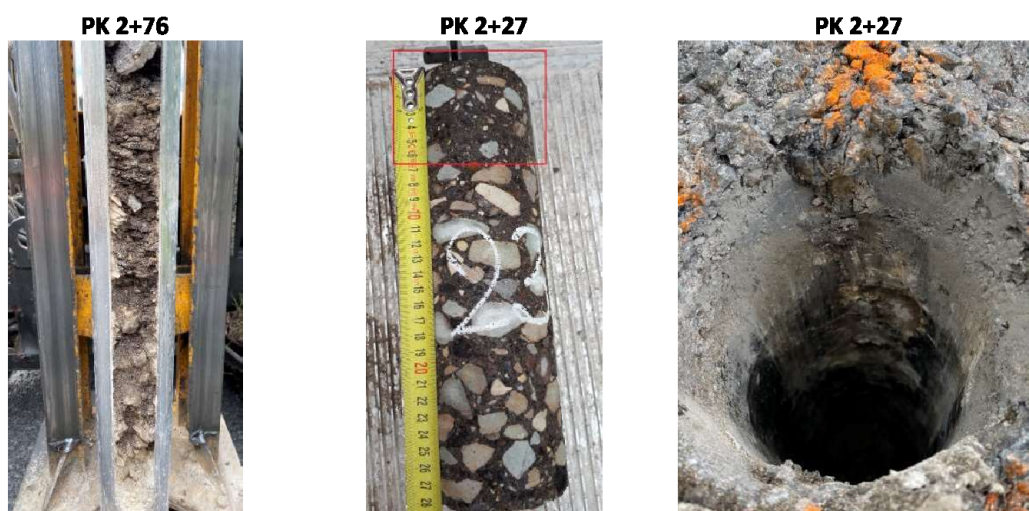
Joonis 7.7. Ristlõige PK 2+76. Uue stabikihi ülaosa oli väga tihe, millest proovliga läbimine oli raskendatud. Stabikiht justkui koosneb kahest erinevast kihist, mis tuleb esile ka mõningate puurkehade põhjal (nr 23, 20, 19, 18, 17). PK 2+27 põhjal nähtus, et põikpragu ulatus on kuni uue stabikihi tiheda osa lõpuni, kus enam edasi ei lähe.
