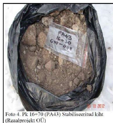
Foto 7.9. 2012aastal katselõigu E puurauk ja kätte saadud stabiliseeritud kihi proov.
