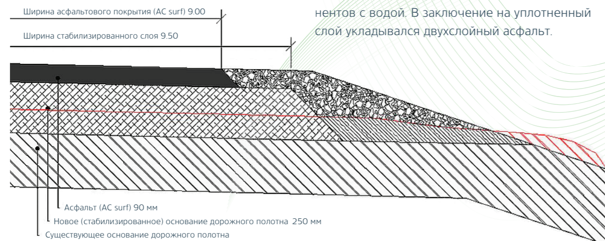
Рисунок 1. Конструкция дорожного полотна экспериментального участка
